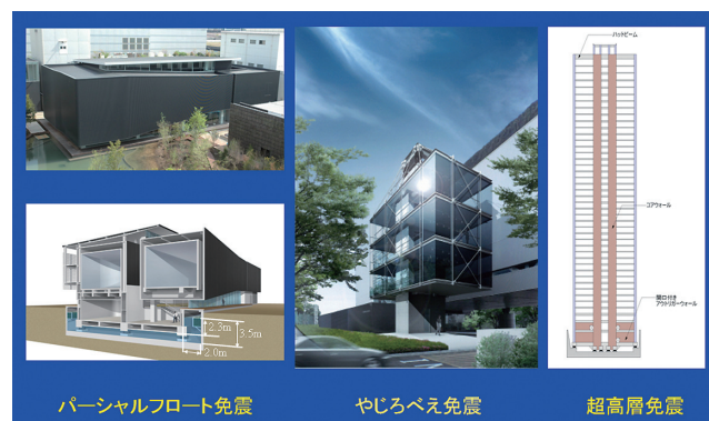
図44 新しい免震技術(清水建設提供)
