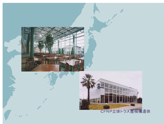
図44 CFRP 立体トラス屋根
