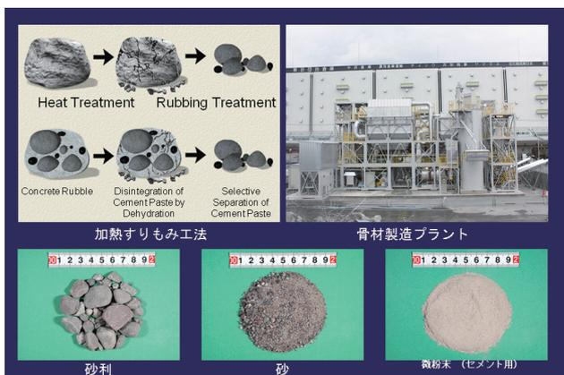
図40 加熱するもみ工法 (清水建設提供)
