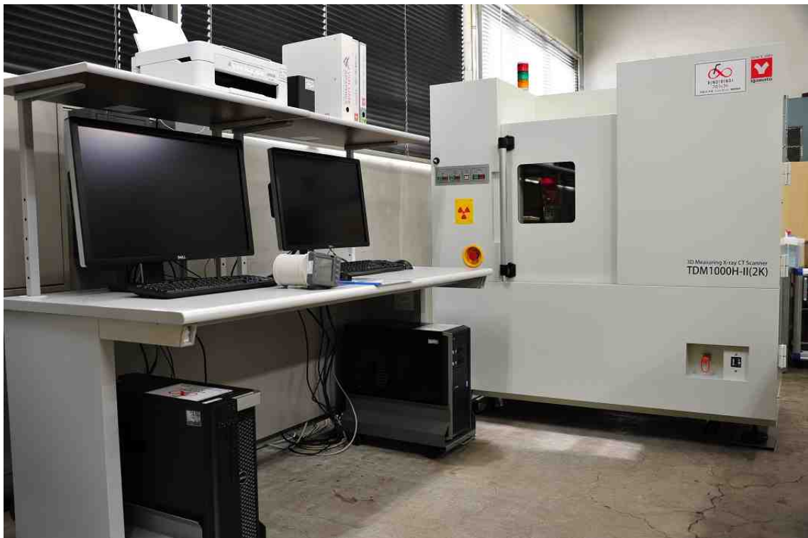
高精細X線CT装置(管電圧 100kV 最小分解能 1.5 \mu m) (公益財団法人 JKA 平成 25 年度機械工業振興補助事業)
