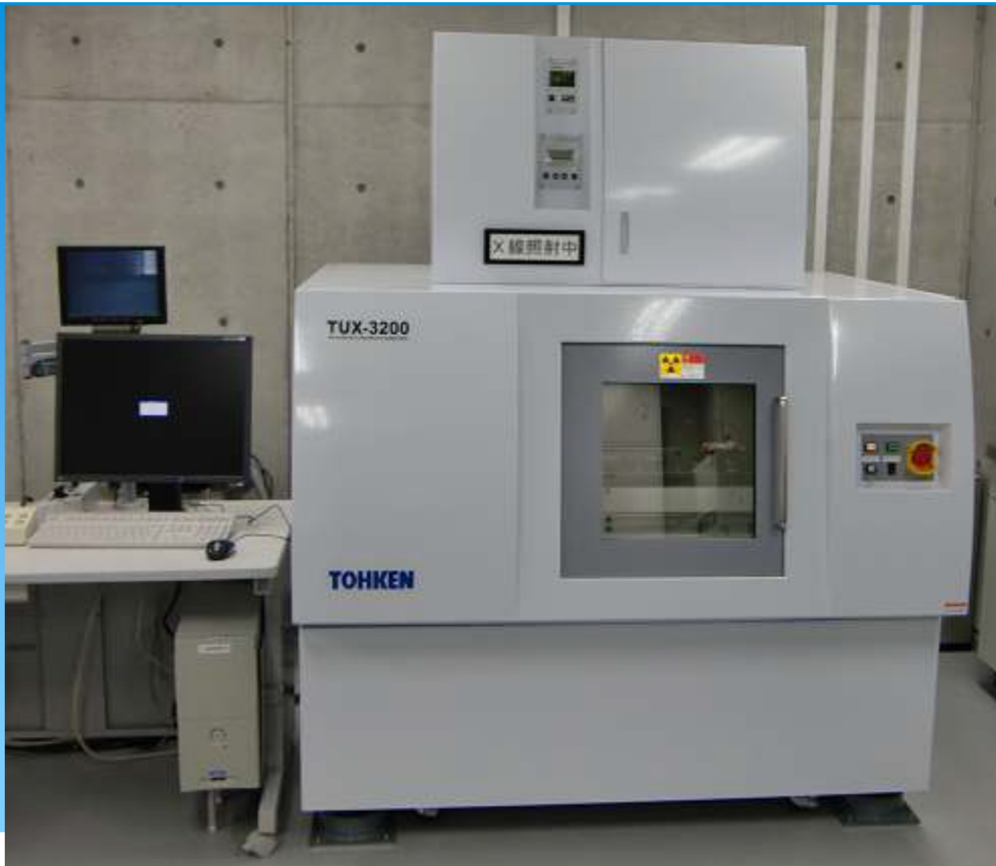
(管電圧40kV, 管電流200 \mu A) X線透過観測装置
