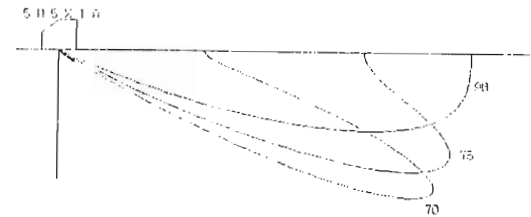
解図12 表面S H波探触子及びS H波斜角探触子の音場
