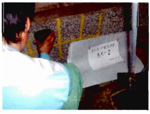
図 22 プロフォメーターによる民家の基礎部分の配筋調査
