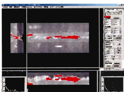
妨害エコー除去同一欠陥処理後
