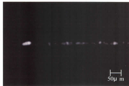
図2. 非金属介在物の検出例(50MHz)
