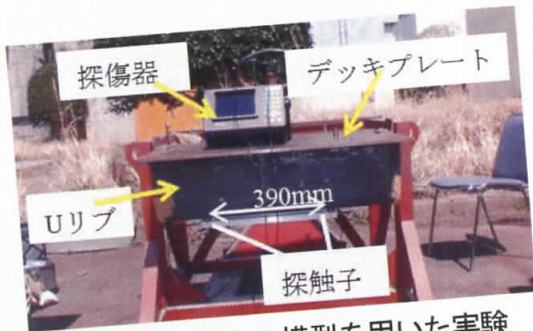
図5 実物大の模型を用いた実験
