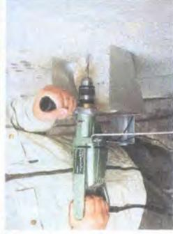
写真-4 ろ紙回転装置付きドリルを用いた技術者1名での試験
