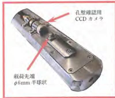
図 13 孔内局部荷重装置
