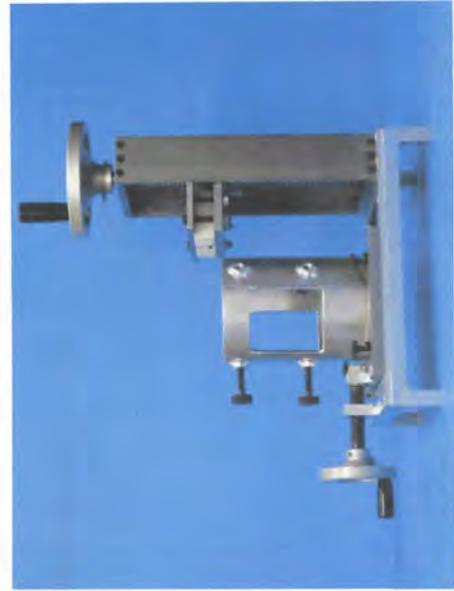
写真 コア側面に適用する引っかけ試験装置(構造総研)
