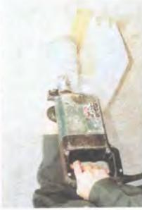
写真4 ドリルによるコンクリート粉末の採取
